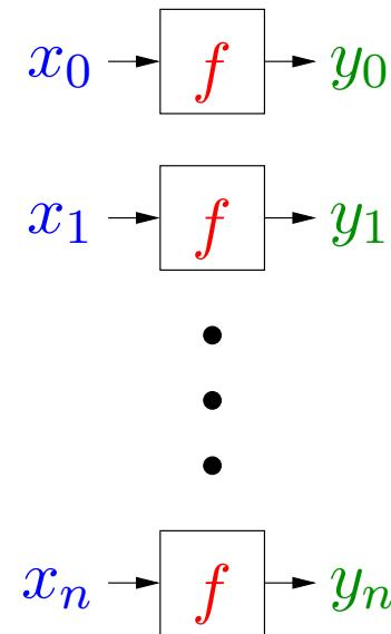
Fazit: alle Anwendungen von  $f$  sind **unabhängig** und könnten, z.B. von einem Parallelrechner **gleichzeitig** ausgeführt werden.
