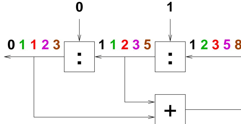
In unserem Hardware-Modell entspricht `(x:xs)` einer Verzögerung des Signals `xs` um eine Zeiteinheit.
